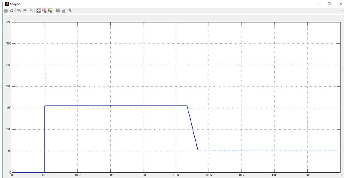
*Simulación SIMULINK 4: Valor medio de rectificado con ángulo de  $60^\circ$  a  $120^\circ$  de tensión alterna 230Vef a 50Hz*
