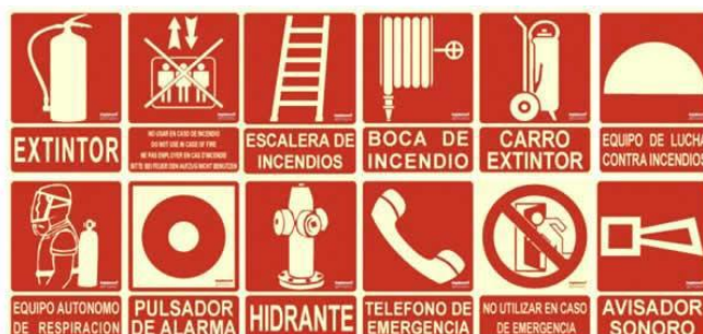
Figura 1. Señalización de los medios de protección contra incendios.
