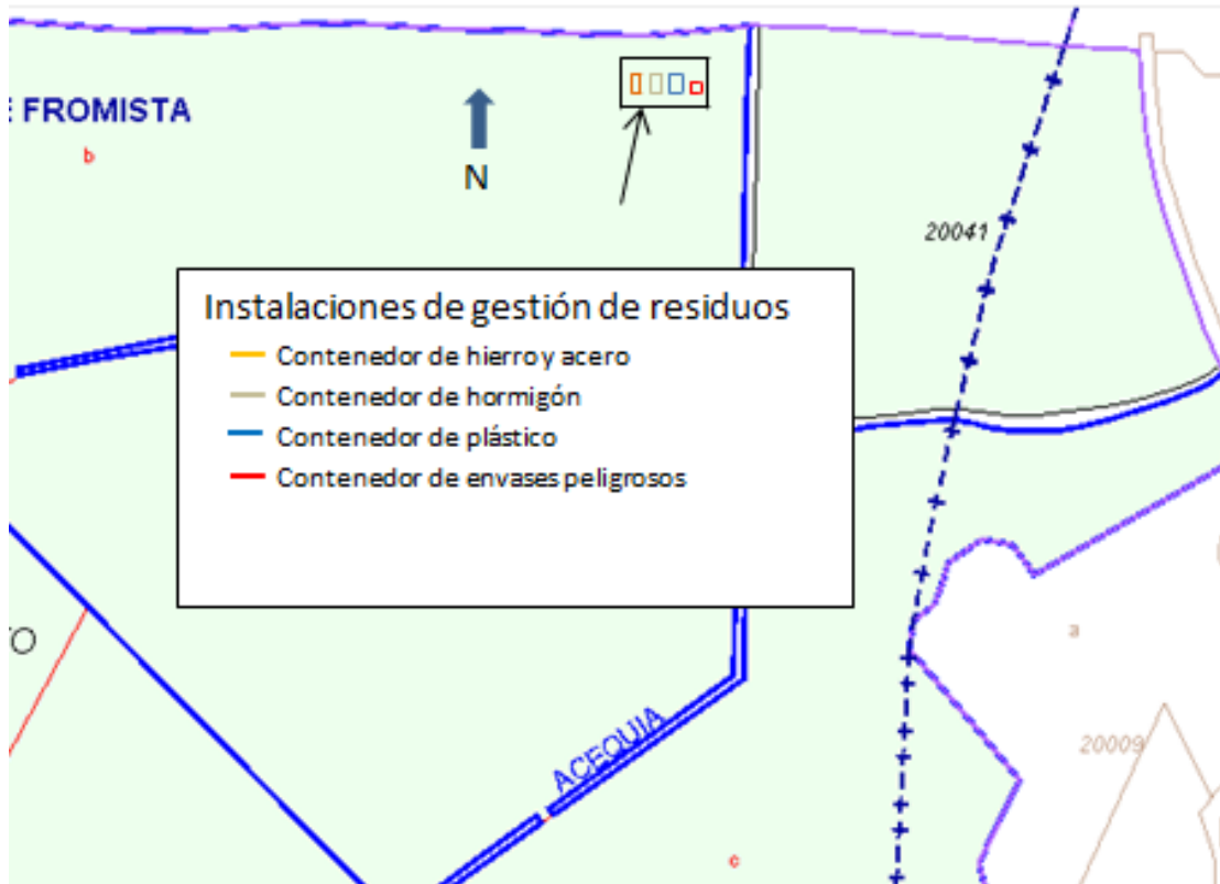
Figura 1. Localización de los contenedores para la gestión de los residuos.
