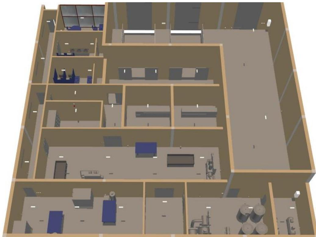
Figura 35. Colocación de las luminarias de emergencia.
