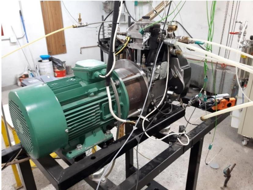
Imagen 14. Motor eléctrico (de color verde) acoplado al motor de combustión.
