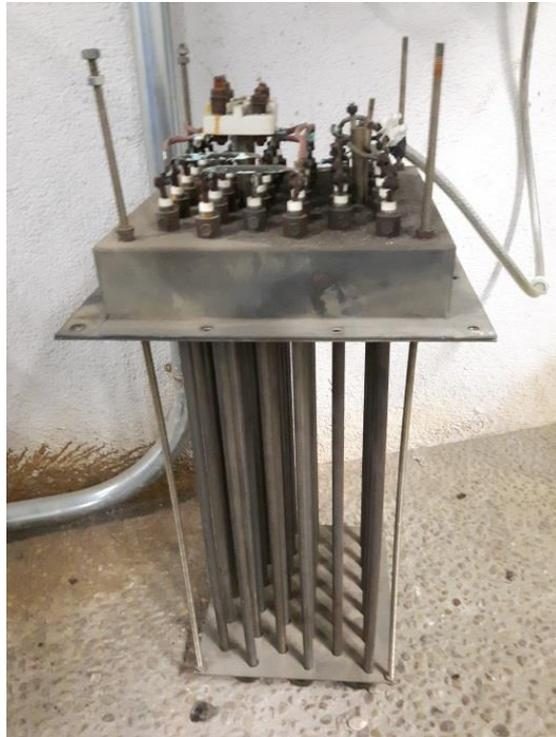
Imagen 25. Resistencia de frenado.
