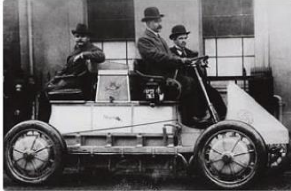
FIG 2.3 Lohner-Porsche con cuatro motores en cada rueda. [3]
