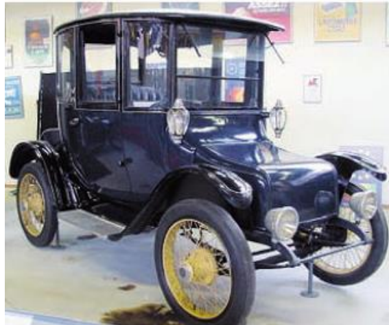
FIG 2.5 Modelo de Detroit Electric dotado de dos motores uno en cada eje. [3]
