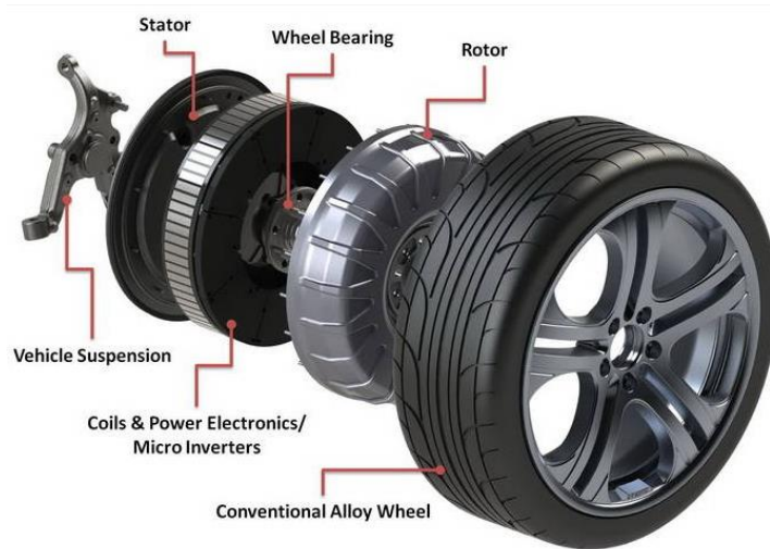
FIG 4.54 Motor eléctrico integrado en la rueda de la compañía Protean electric. [23]
