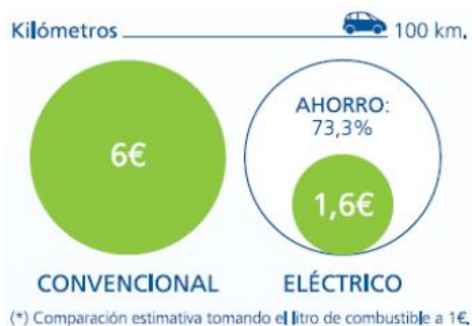
FIG 2.9 Comparación de ahorro energético entre vehículo diésel y eléctrico. [7]
