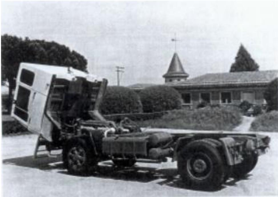
*Fig 2.3 Sistema de Cabina Basculante en Pegaso tipo 1180*
