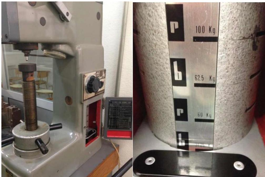
Figura 4.7. Izquierda: Durómetro empleado para el ensayo de macrodureza. Derecha: Carga empleada durante el ensayo.
