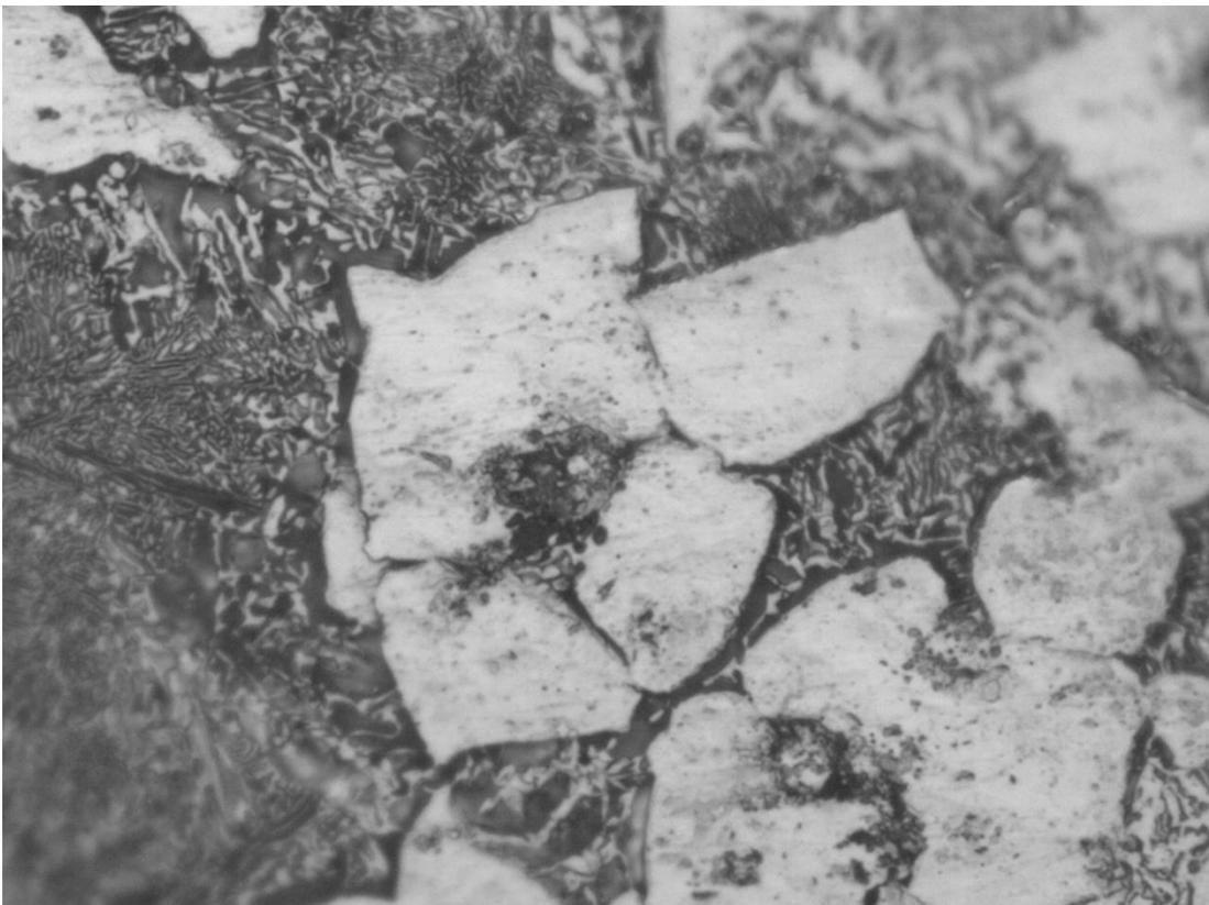
Figura 7.17: Micrografía de acero dúplex MIM sinterizado bajo vacío a 400x.
