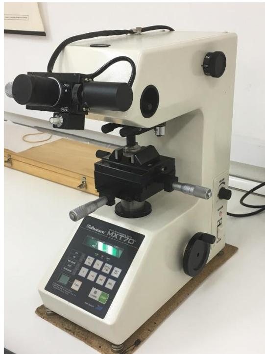
Figura 4.6: Microdurómetro MXT70 empleado para hacer los ensayos.
