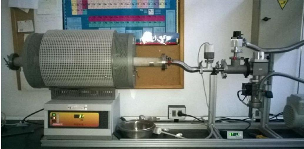
Figura 4.2: Horno cerámico horizontal Carbolite STF 15/180 utilizado para el proceso de sinterizado.
