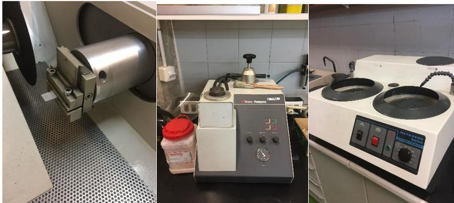
Figura 4.3: De izquierda a derecha, sujeción tronadora, máquina de empastillado y uno de los equipos empleados en el desbaste de probetas.
