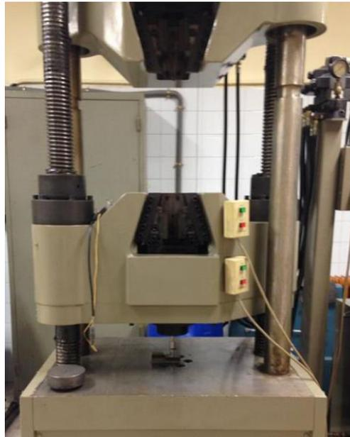
*Figura 4.1: Prensa hidráulica de compactación.*
