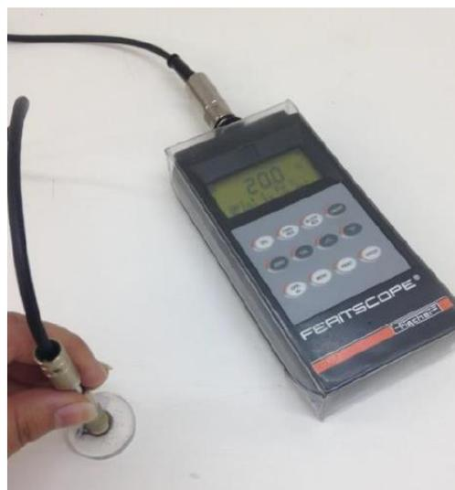
Figura 4.4: Ferritómetro realizando una medición de ferrita existente en una probeta.
