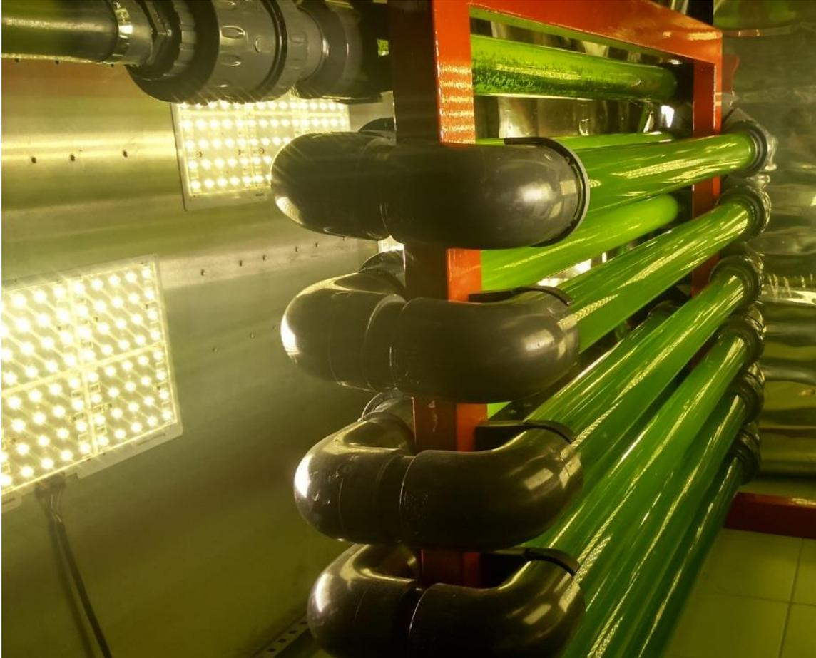
*Figura 3.30. Fotobiorreactor tubular*
