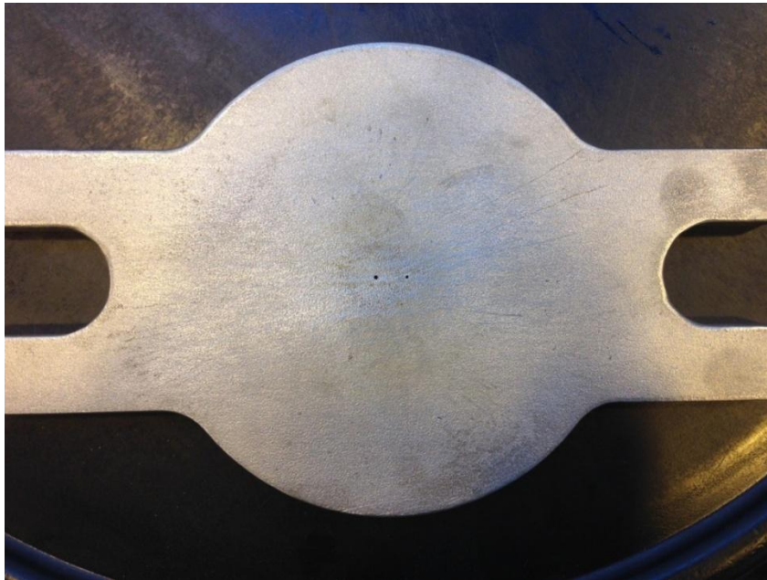
Imagen 10. Placa con 2 orificios colocada a la entrada del reactor.
