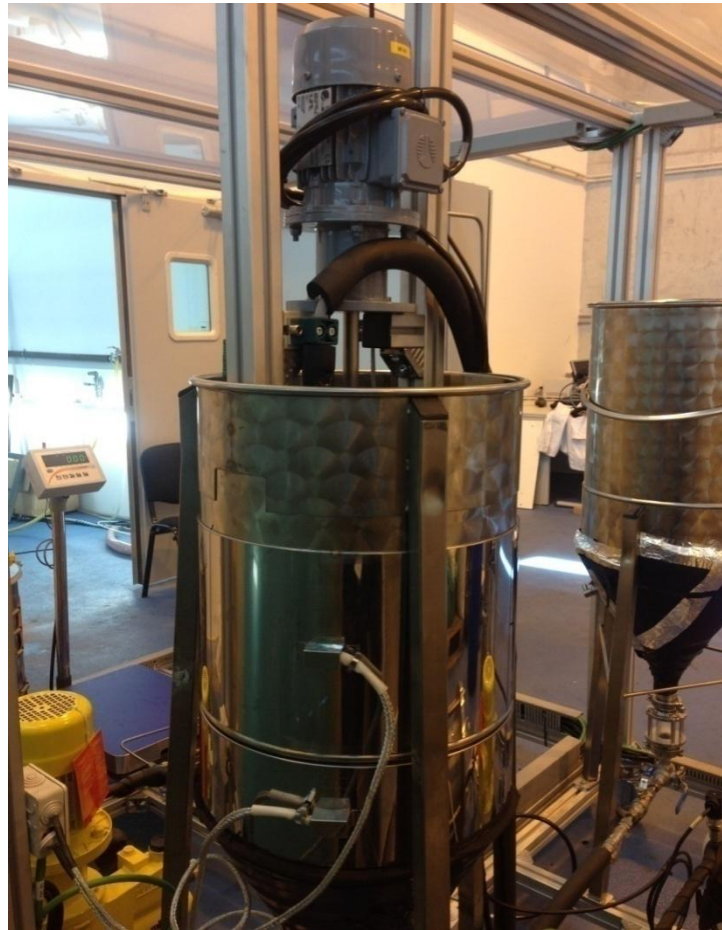
Imagen 3. Depósito de mezcla de los reactivos del proceso.
