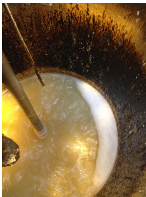
Imagen 16. Formación de jabones en la prueba 8.
