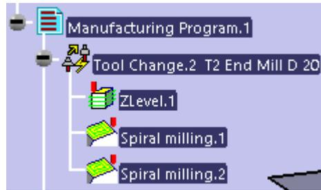
Imagen 41. Operaciones creadas en el árbol por Machining/ Slope Area.
