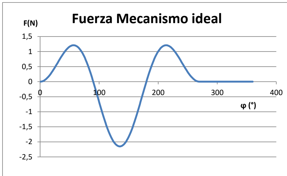
Figura 46. Diagrama de fuerzas ejercidas por la leva en el seguidor, mecanismo ideal.
