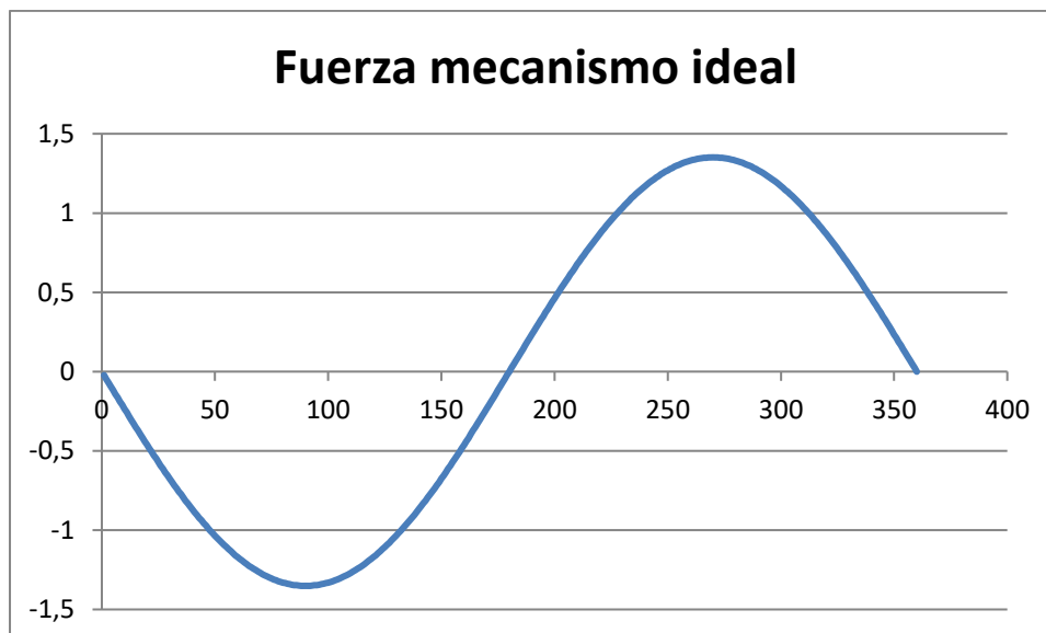
Figura 17. Diagrama de fuerzas ejercidas por la leva de excéntrica en el seguidor, mecanismo ideal.
