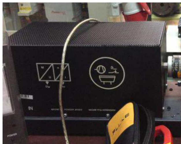
Figura 3.8 Freno de polvo magnético Lucas-Nülle
