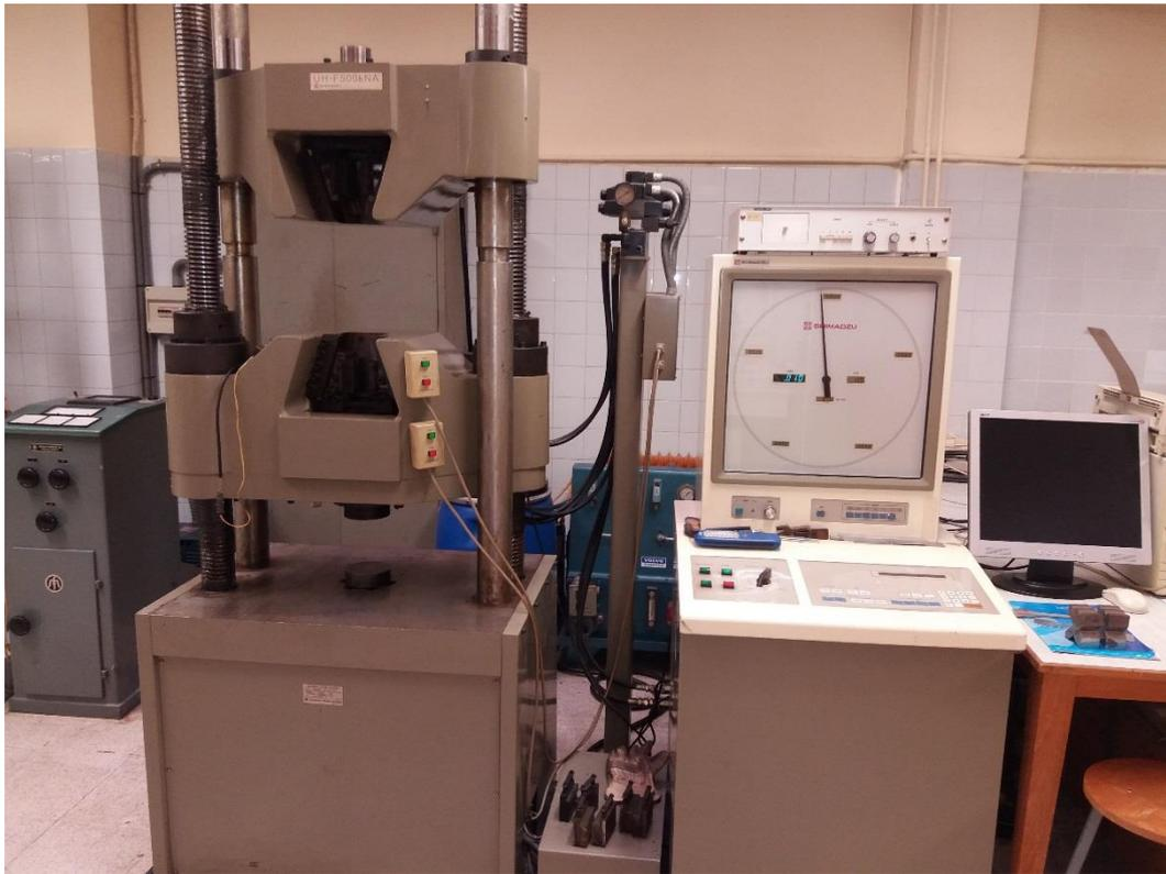
Fig. 7.15. Máquina ensayo de tracción
