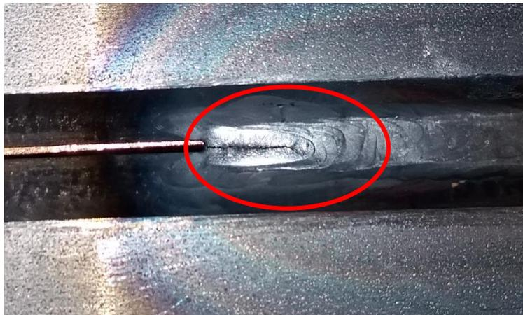
Fig. 7.3. Grieta en el cordón de soldadura del cupón 1
