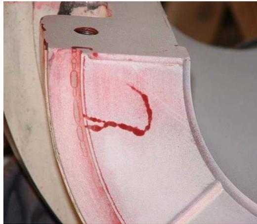
Fig. 4.8. Ensayo con penetrantes coloreados.
