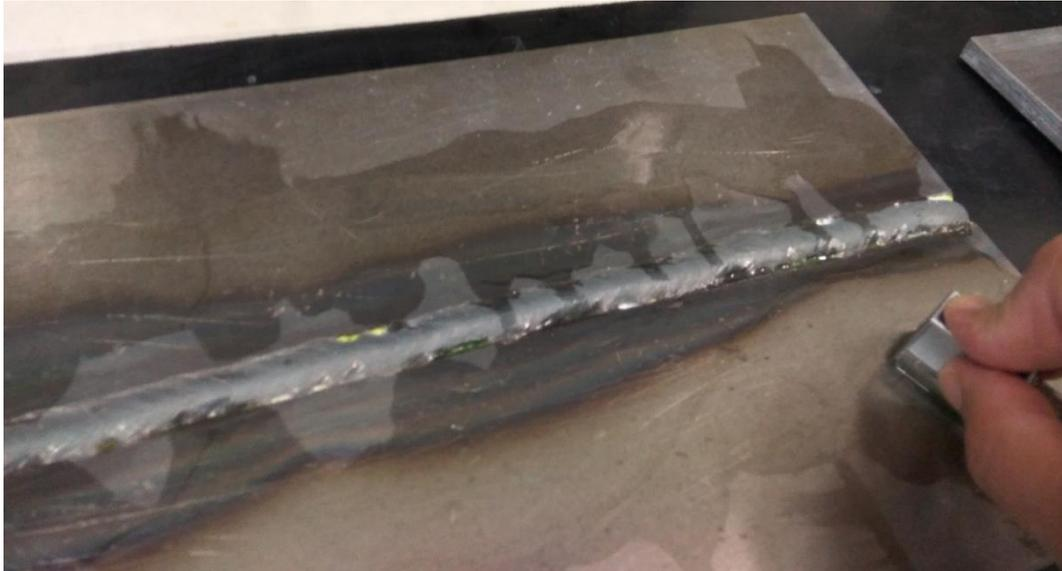
*Fig. 7.35. Inspección por ultrasonidos*
