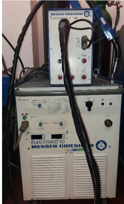
Fig. 2.14. Equipo de soldadura MIG/MAG
