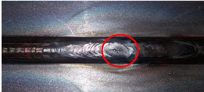
Fig. 7.8. Grieta de cráter en el cordón de soldadura del cupón3.
