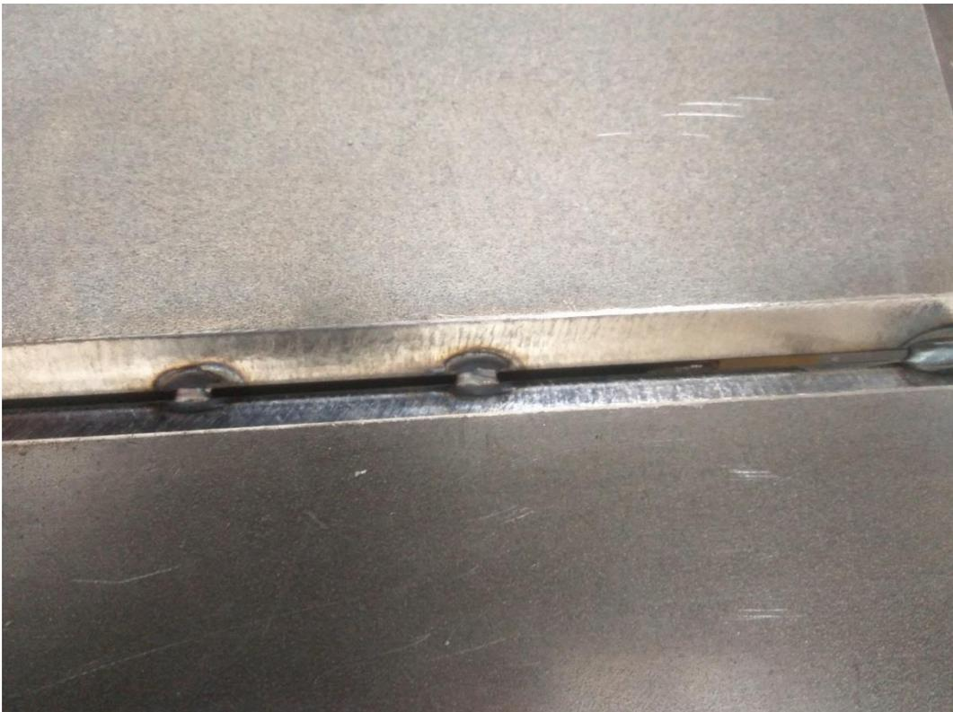
*Fig. 7.26. Ampliación punteado del cupón*
