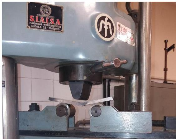
Fig. 7.18. Máquina para ensayo de doblado
