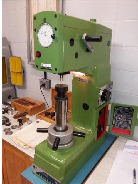
Fig. 7.22. Durómetro Brinell
