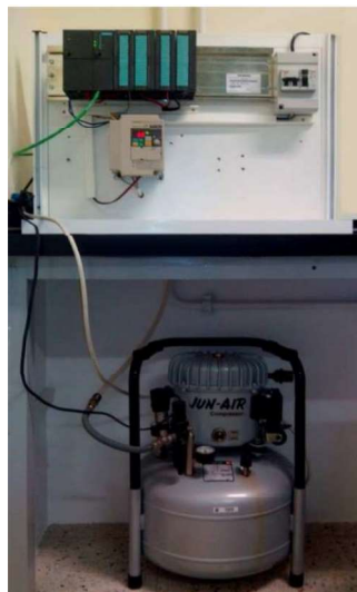
Figura 4.1 – Lazo de control de presión
