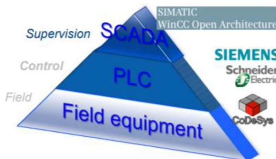
Figura 1.2 – Arquitectura de un sistema de control aplicada a UNICOS
