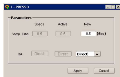
Figura 3.6 – Configuración del tiempo de muestreo y el tipo de acción
