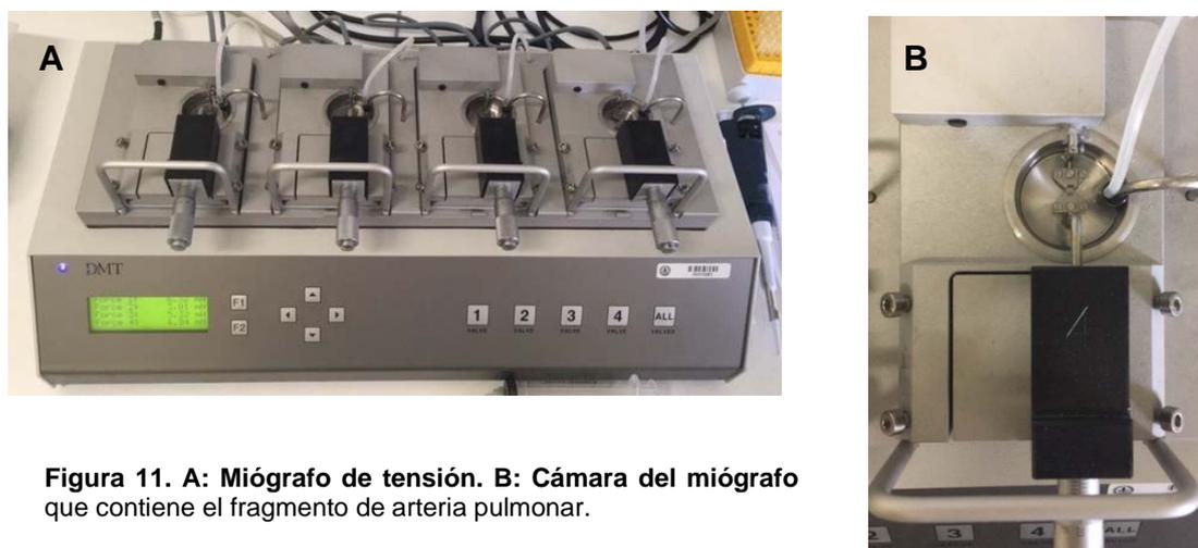
**Figura 11. A: Miógrafo de tensión. B: Cámara del miógrafo que contiene el fragmento de arteria pulmonar.**
