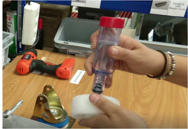
Figuras.55.y 56. Montaje y engrasado de casquillo cojinete rueda
