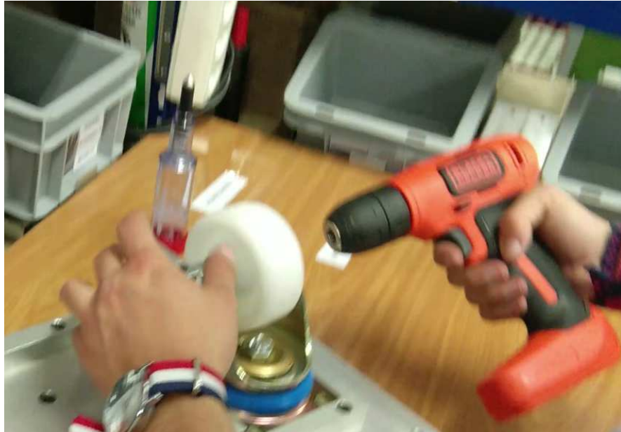
Figura.57. Apriete de tuerca con ayuda del útil poka yoke
