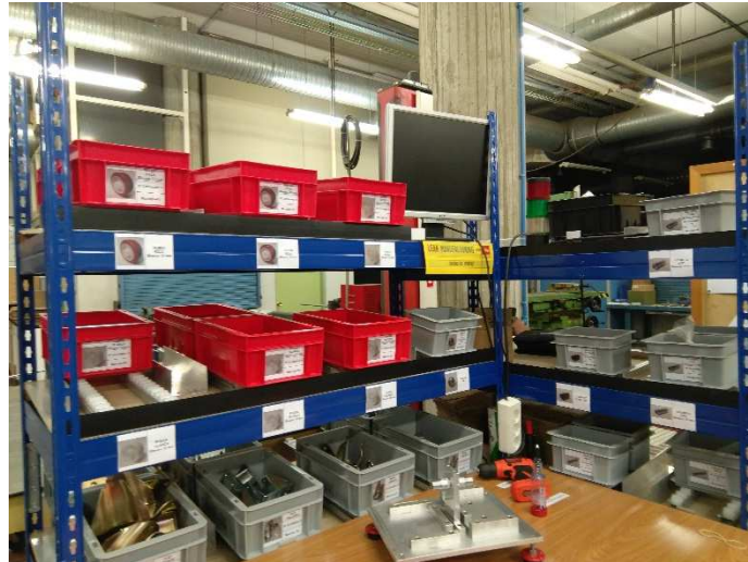
Figura.60. Aprovisionamientos colocados en orden lógico en el puesto
