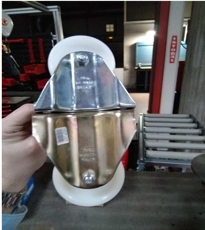
Figura 8. Soportes fijos (con ruedas montadas)
