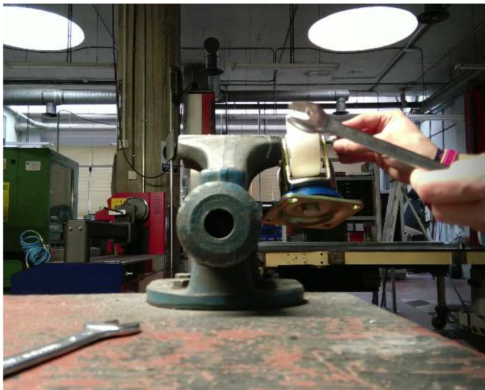
Figura 21. Sujeción mediante tornillo de banco.
