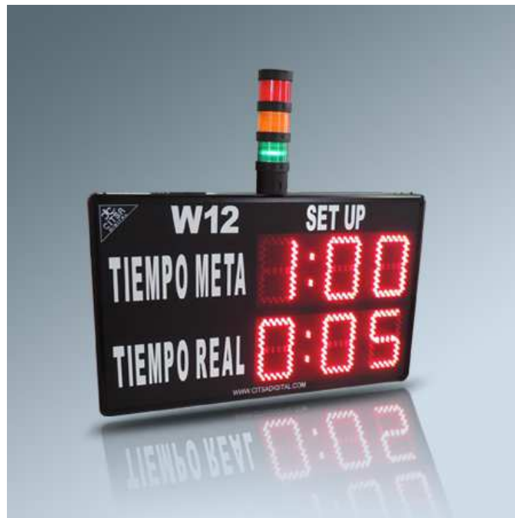
Figura 25. Cronómetro con Takt time del proceso, tiempo real e indicador andon en parte superior. (Idealizado).
