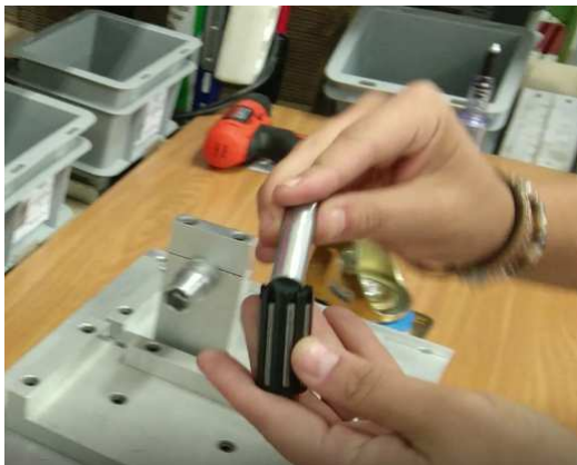
Figuras.55.y 56. Montaje y engrasado de casquillo cojinete rueda
