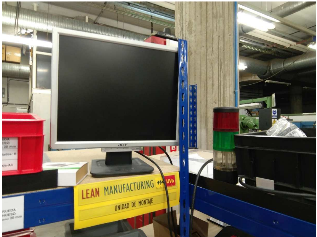
Figura 26. Monitor con Takt time del proceso, tiempo real e indicador andon en parte derecha (Reales en el puesto).
