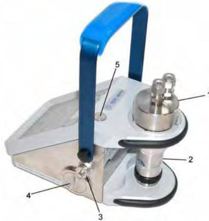
Ilustración 82 Orbisphere 3650 1-Cámara de Flujo 2-Sensor electroquímico 3-Puerto RS-232 4-Batería 5-Sensor de presión barométrica, válvula de alivio Fuente: *Manual Orbisphere 3650*
