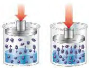
Ilustración 3 Variación de la disolución de un gas en una disolución al aumentar la presión.
