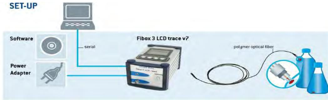
Ilustración 8 Montaje del sensor luminiscente Presens Fibox 3 LCD Trace. Fuente: Manual Fibox 3 LCD trace Fiber optic oxygen transmitter
