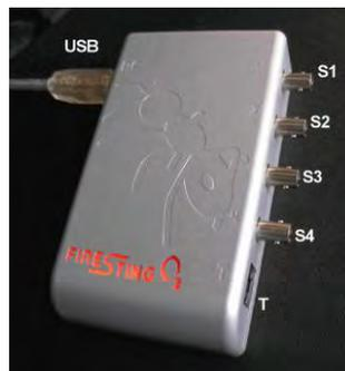
Ilustración 60 Conexiones del equipo
