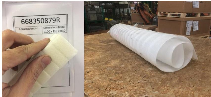
Figure 30. Mousse pour les capots
