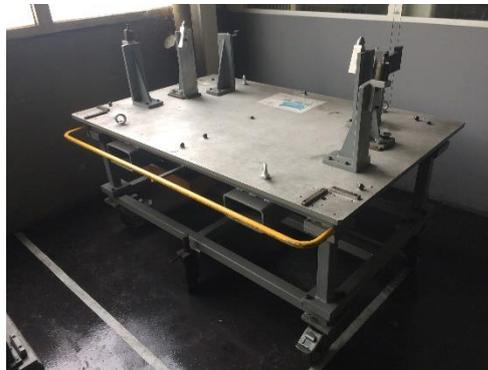
*Figure 33. Maquette de mesure 3D, Capot J95*
