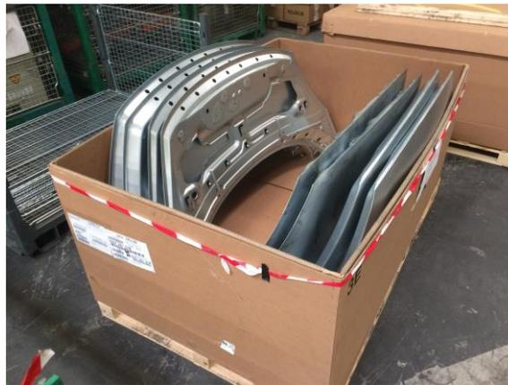
*Figure 27. Capots finis dans une caisse en carton*
