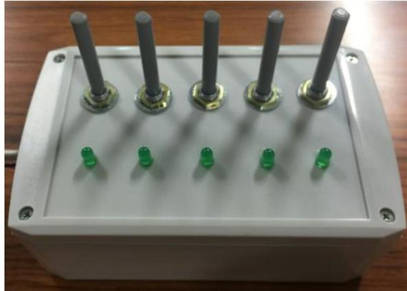
*Figura 5.66: Caja de conexiones reguladores (Elaboración propia)*
