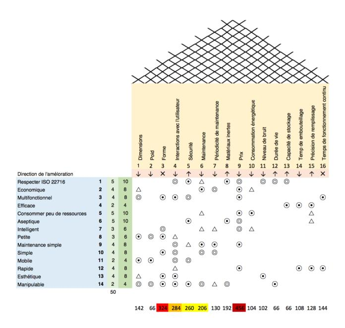
Selon les données obtenus, les métriques les plus importants sont: le prix total pour la construction de la machine, la forme qui va définir le système mécanique, l'interaction avec l'utilisateur, la sécurité et la maintenance.
