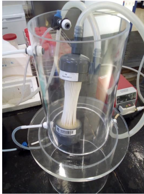
Figura 12. Depósito con membrana
