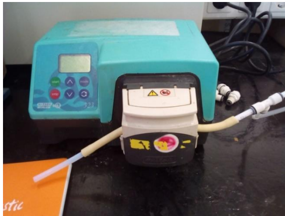
Figura 14. Bomba utilizada para la alimentación y recirculación
