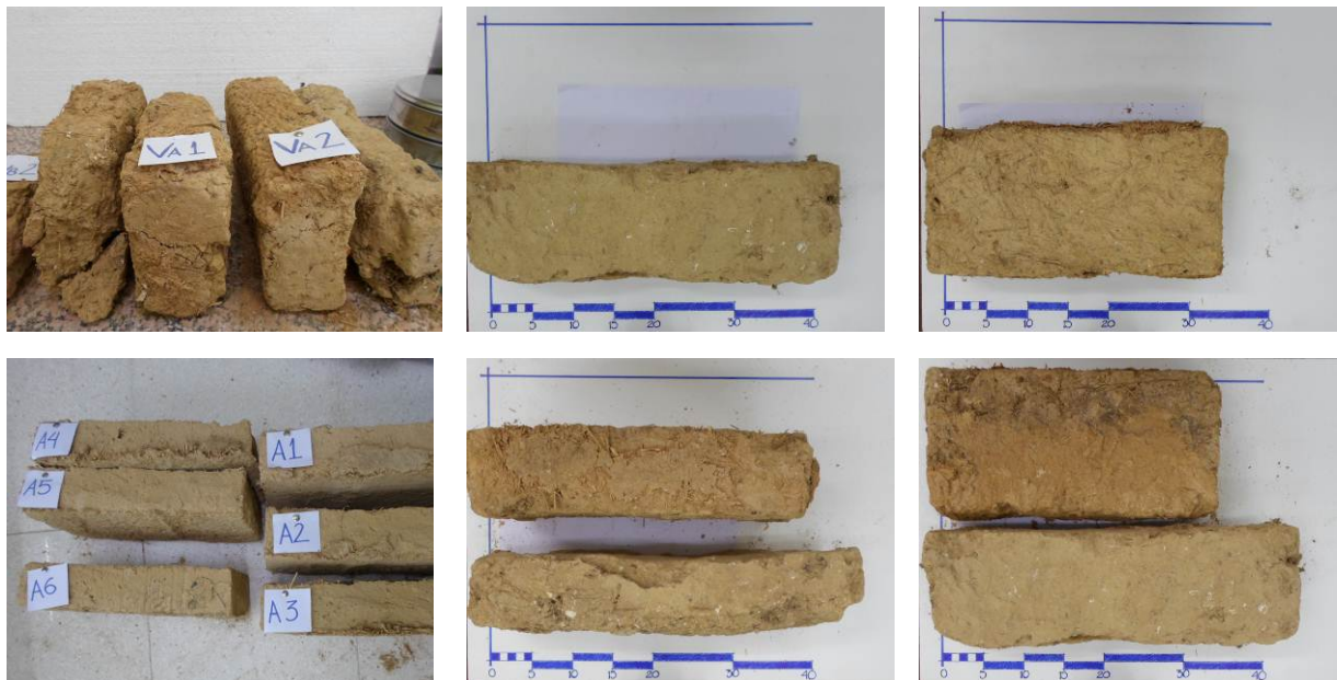
Figura 6. Casa-Hospital de la Vera Cruz de San Juan, Villalón de Campos, España. Ensayos de Laboratorio. Caracterización de adobes; tipos Va1/Va2 HVC (GrupoTIERRA, 2015)
