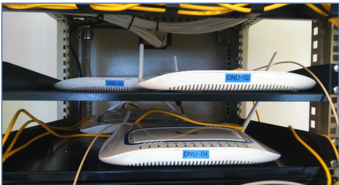
Figura 6. Vista frontal de las ONUs/ONTs en la red de acceso GPON del laboratorio
