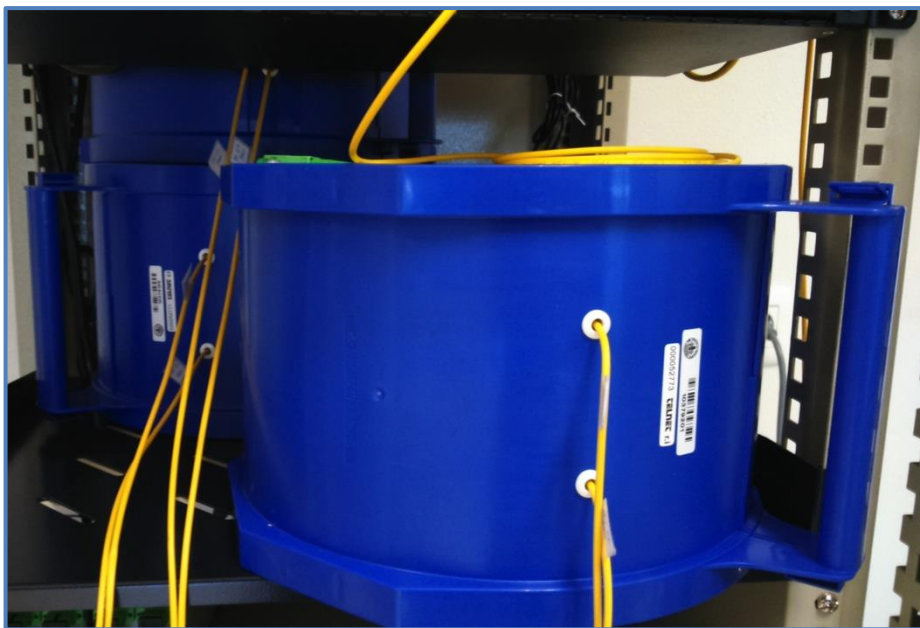
Figura 7. Bobinas de fibra óptica en el montaje GPON realizado en el laboratorio
