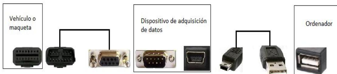
Ilustración 57: Esquema de las conexiones del dispositivo de adquisición de datos
