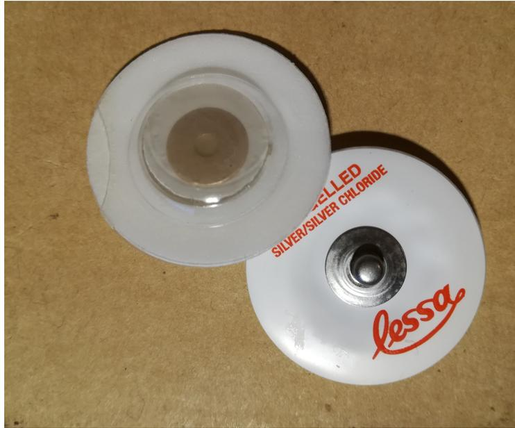
Figura 1.1: Electrodo utilizado para capturar la señal mioeléctrica.
