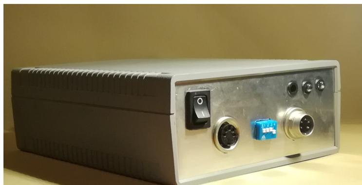
Figura 1.3: Cabecera de adquisición de señales mioeléctricas.
