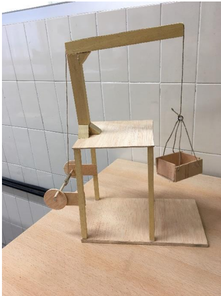
Figura 8: Grúa montacarga final
