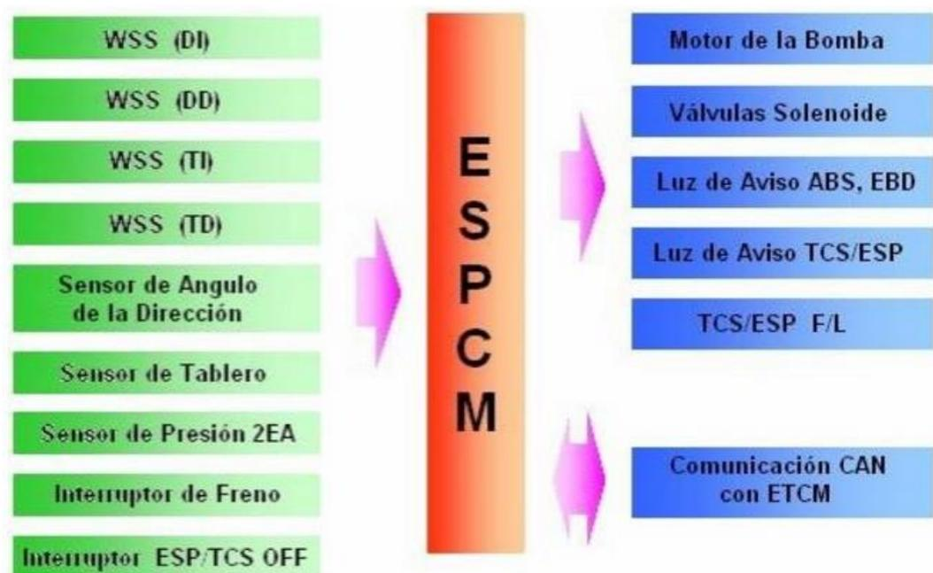
Figura 14. Entradas y salidas del ESP
