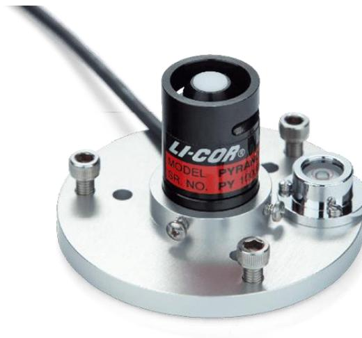
Figura 24. Piranómetro fotodetector.
