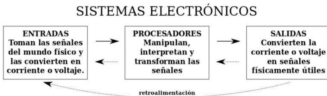
Figura 4. Diagrama de un sistema electrónico.
