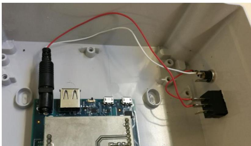
Figura 60. Conexión de la alimentación.
