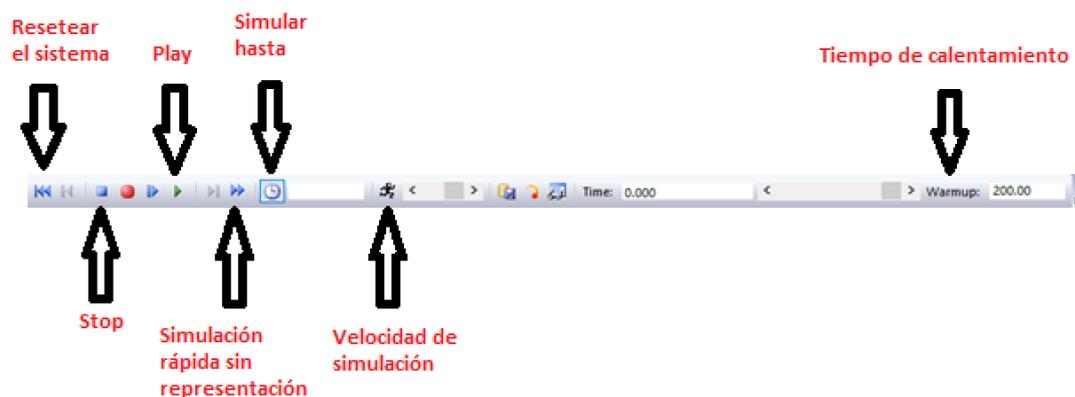
FIGURA 3.3 BARRA DE SIMULACIÓN
