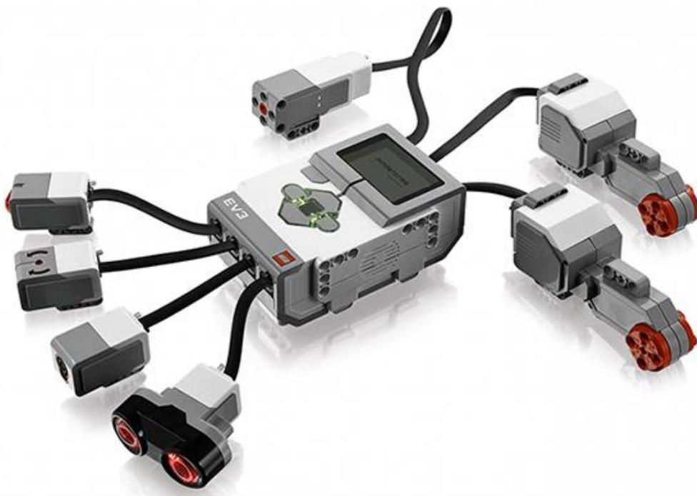
*Ilustración 1. Bloque EV3 con sensores y actuadores. [1]*
