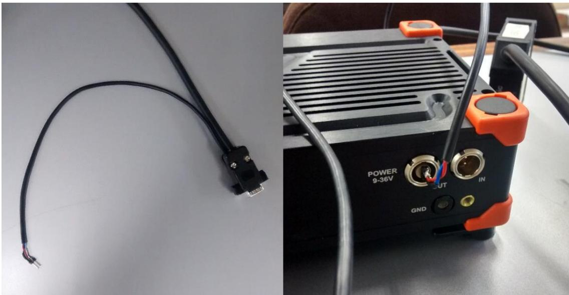
Ilustración 14. Conexión de la alimentación del láser [4]
