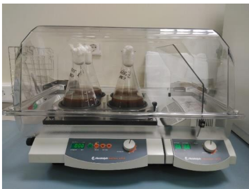
Figura 1. Equipo de incubación HEIDOLPH incubator 1000 con sistema de agitación HEIDOLPH Unimax 1010
