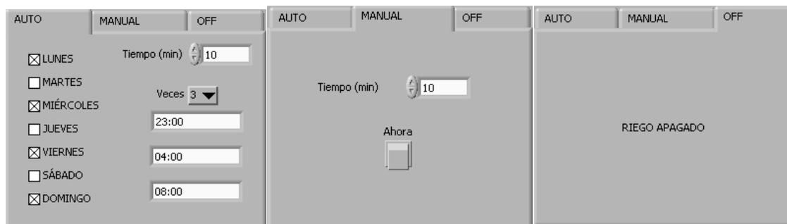
Si seleccionamos el modo auto, como se puede observar, se trata de un control de riego bastante completo, el cual nos permite seleccionar los días de la semana que se desea regar y utilizando la misma estructura que en el caso de la iluminación interior, se ofrecen hasta tres horas diferentes de riego a lo largo del día. Asimismo se puede configurar el tiempo (en minutos) que se desea que el riego esté en funcionamiento.
