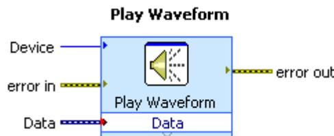
Dicho bloque nos permite, sin realizar complicados ajustes, reproducir de una forma sencilla los datos que se introducen por el terminal “Data” a través de nuestro sistema de sonido.
