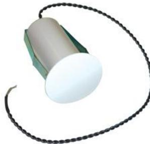
El CHV-RTS es un sensor de temperatura remoto de pared. Usando cables de baja capacitancia, el sensor remoto puede instalarse hasta a 500 pies del termostato. Se trata de un sensor de montaje de una sola pieza y de par trenzado de conexión no polarizado. La cara de 1-1/2 pulgadas de diámetro sobresale sólo 1/8 de pulgada de la superficie de la pared y es fácil de pintar o empapelar.
