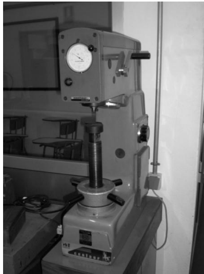
Máquina Centaur rb2 utilizada para realizar los ensayos
