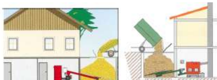
Figura 16. Silo enterrado fuera del edificio
