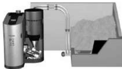
Figura 24. Transporte del pellet del silo a la caldera mediante sistema neumático
