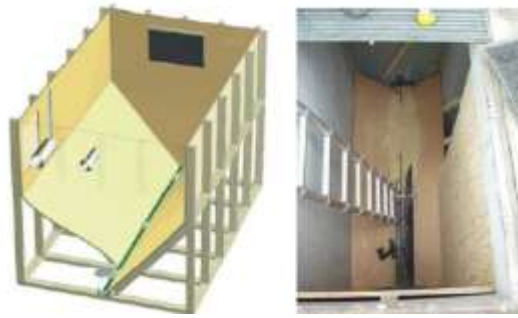
Figura 14. Silo para pellets (aéreo y enterrado)
