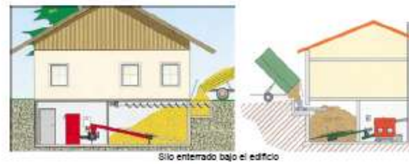
Figura 17. Silo enterrado bajo el edificio
