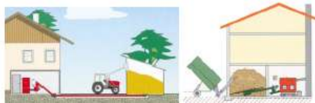
Figura 18. Silo sobre rasante fuera y dentro del edificio
