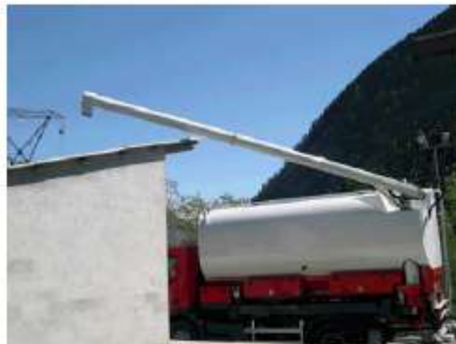
Figura 19. Descarga del pellet del camión mediante cóclea (sin fin)
