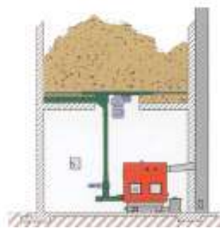
Figura 15. Silo enterrado bajo cuarto de caldera
