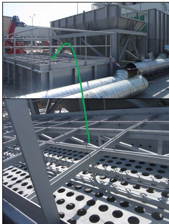
Figura 1-2-9. Filtro sin montar con zoom en los orificios bajo los que cuelgan las mangas
