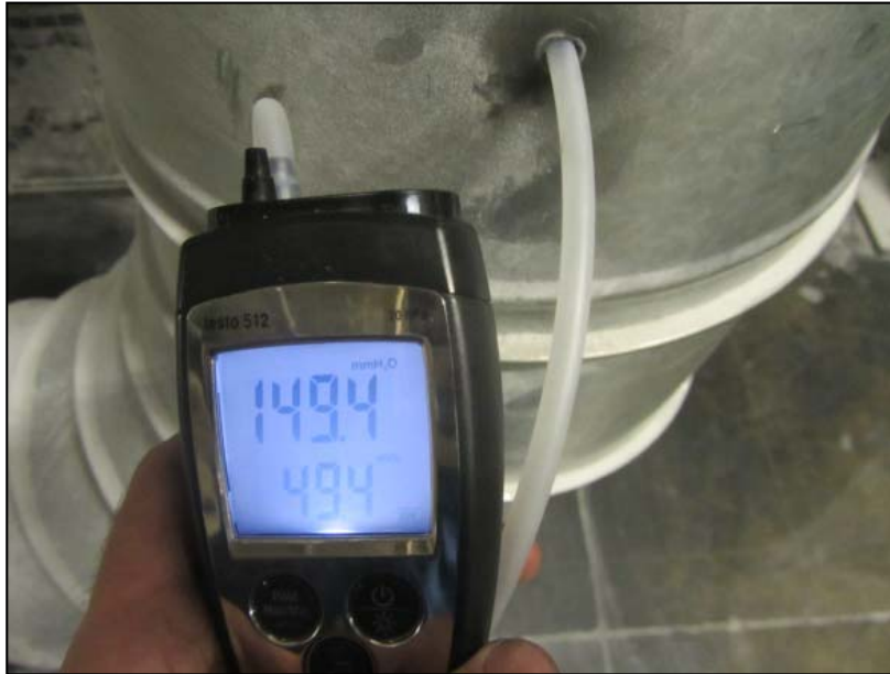
Figura 4-3-2. \Delta p con el medidor TESTO
