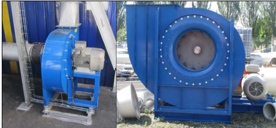
Figura 1-2-10. Ventiladores accionados por motores eléctricos
