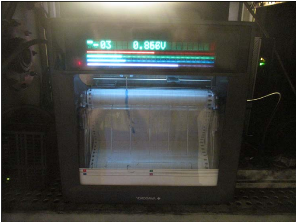
Figura 4-4-7. Registrador de papel en prueba piloto
