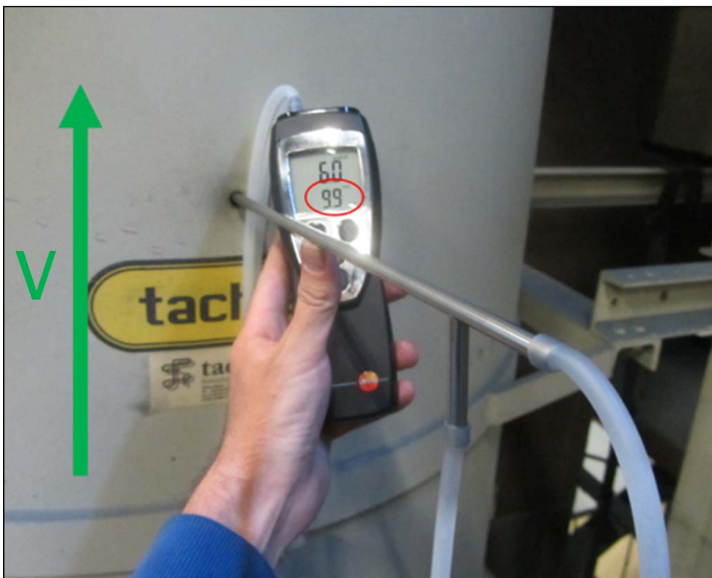
Figura 1-3-9. Medición con tubo de Pitot enfrente al aire
