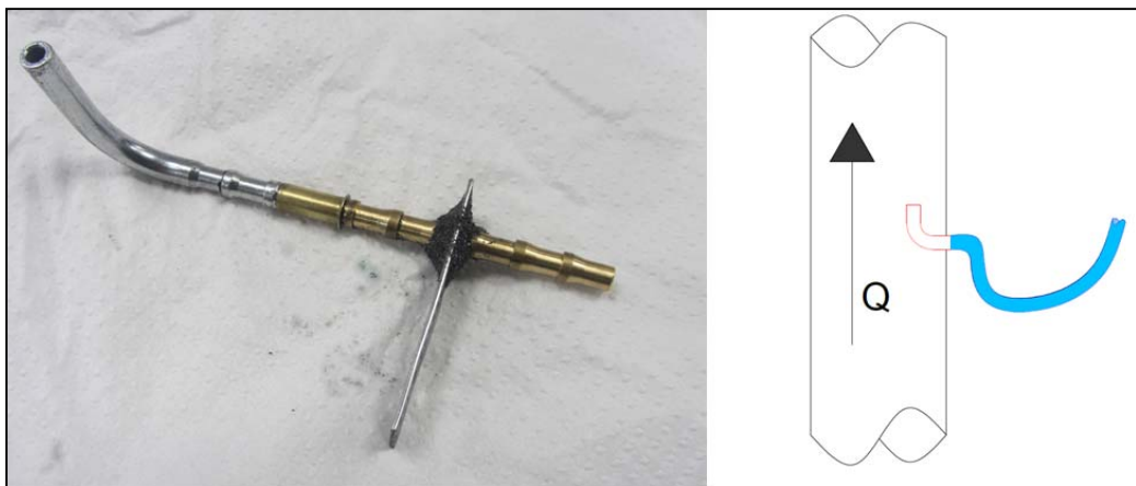
Figura 4-4-6. Conexión manga en prueba piloto
