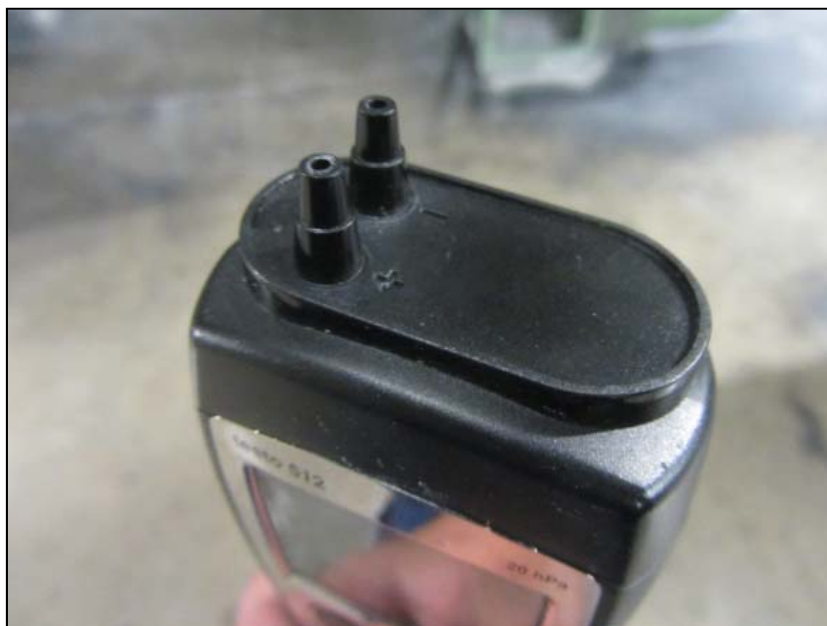
Figura 4-3-1. Entradas medidor TESTO
