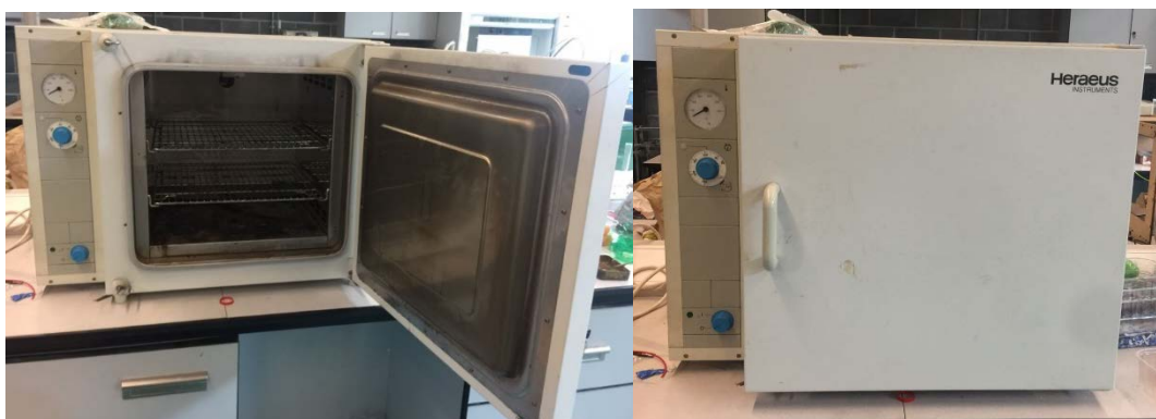
Figura 30. Horno utilizado para la degradación de las muestras.
