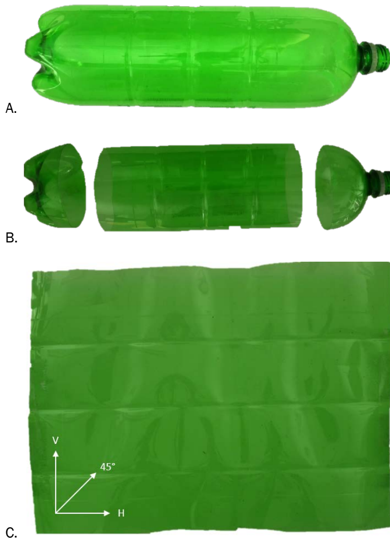
Figura 23. A. Botella completa. B. Separación por partes. C. Lámina de plástico curvada.
