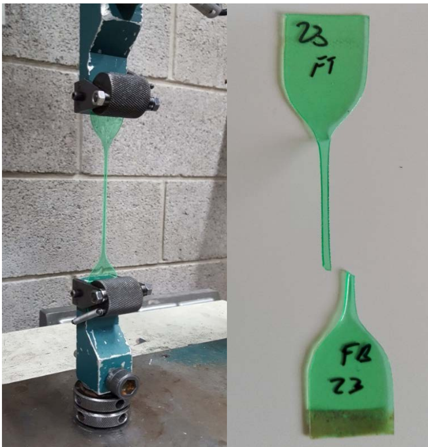
Figura 31. Máquina de ensayo de tracción y muestra después de un ensayo.
