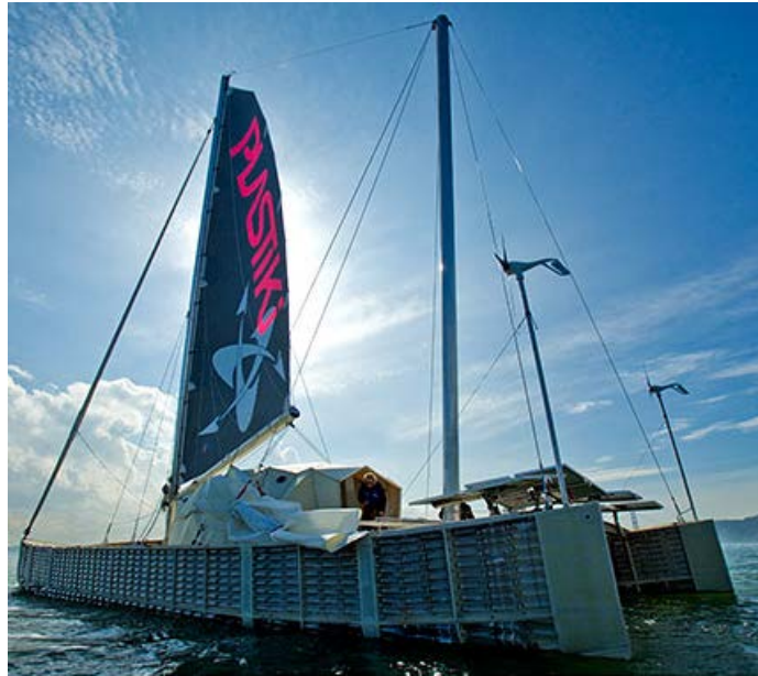
Figura 21. Barco 'Plastiki' creado con botellas enteras de PET (The Plastiki 2017)
