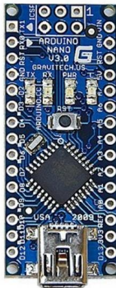
Ilustración 3 Microcontrolador Arduino Nano
