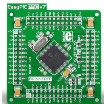
Ilustración 1 Zócalo de Mikroelektronika con un PIC 18F87K22 compatible
