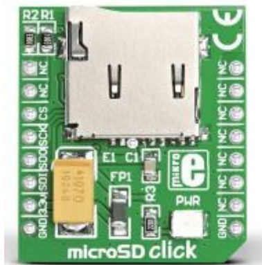
Ilustración 22 Módulo lector de tarjetas microSD de mikroelektronika
