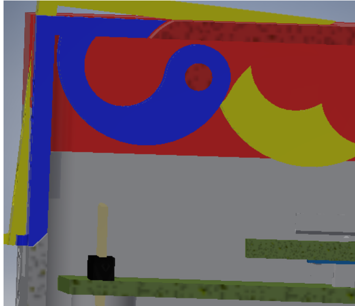
Ilustración 39 Vista en corte de la trampilla cerrada y el mecanismo oculto
