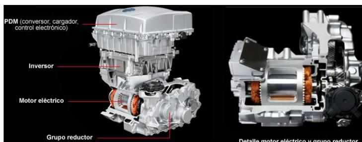
Figura 2.30 Detalle del sistema eléctrico y del grupo reductor del Nissan Leaf. (Dani meganeboy, 2017)
