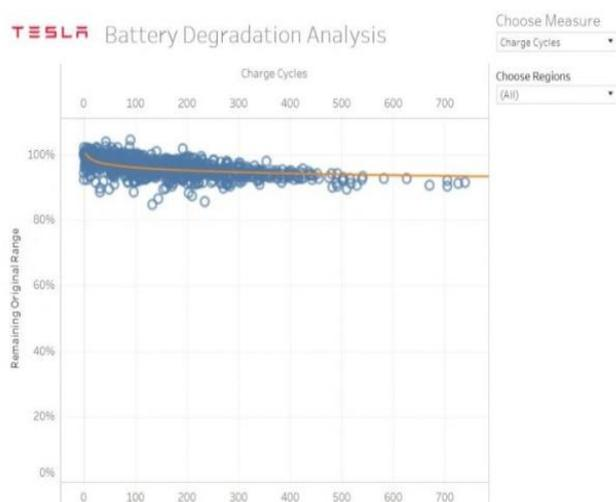
Figura 4.9 Degradación en laboratorio de la batería de Tesla según el número de ciclos realizados. (HYE, 2018)
