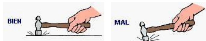
Fig. 7: Forma de golpear sobre una superficie
