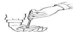
Fig. 14: Sujeción incorrecta de una pieza a atornillar
