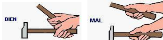
Fig. 6: Forma de sujeción del mango
