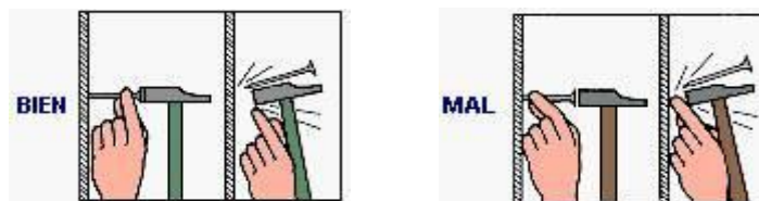
Fig. 8: Forma de sujetar un clavo antes de clavarlo
