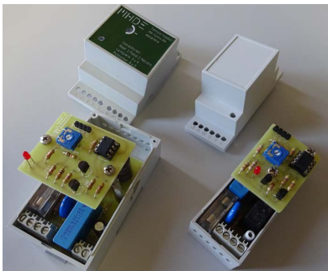
Figura 4: Temporizador de escalera implementado en la experiencia.
