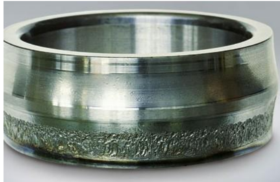
Figura 10: Escamación del rodamiento debido a un exceso de carga axial. [8]
