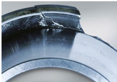
Figura 7: Rotura de la pista interior. [8]
