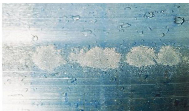
Figura 9: Descamación del rodamiento. [8]
