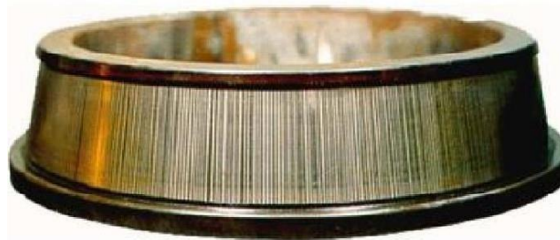
Figura 11: Rayado debido al paso de la corriente eléctrica. [8]
