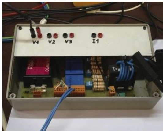
Figura 23: Tarjeta dedicada con los transductores. [13]
