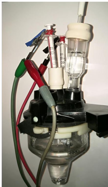
Figura 12: Montaje de la celda electroquímica.
