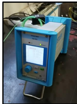
Figura 19: Aspecto del amplificador de la instalación. Modelo: Kistler 5015
