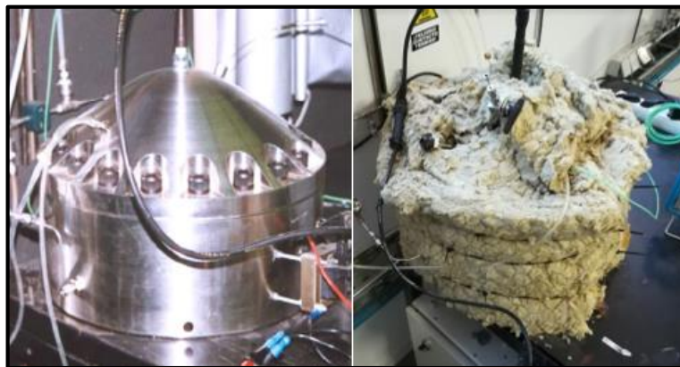
Figura 9: Aspecto exterior de la BCVC sin aislante (izquierda) y con aislante (derecha)
