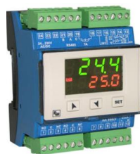
Figura 15: Controlador PID modelo. Valor inferior: Temperatura de consigna. Valor superior: Variable de entrada recibida del termopar. Modelo: Toho TTM-104
