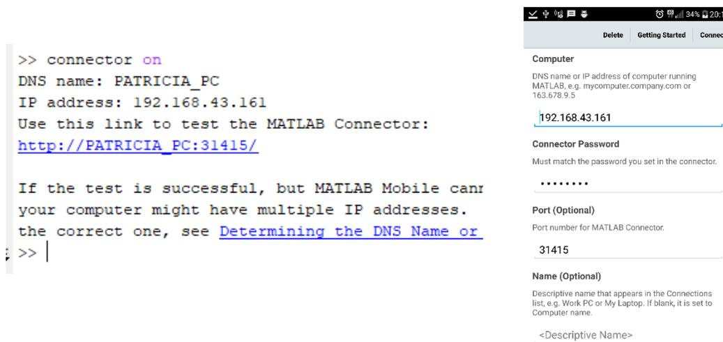
Figura 2.2.1.12-A la izquierda, datos de la conexión que el comando `connector on` devuelve. A la derecha, conexión establecida en la aplicación móvil.
