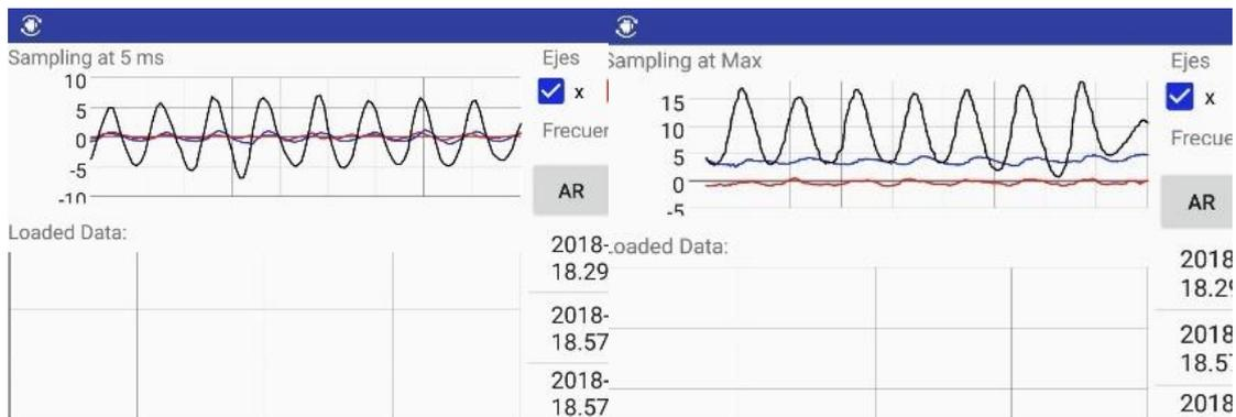
Figura 2.1.2.8-Registro en tiempo real: a la izquierda con la gravedad eliminada, a la derecha con ella activa.
