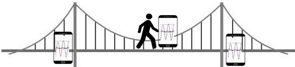
*Figura 4.1.1-Posibilidad de red de sensores que registre aceleraciones producidas en un puente por peatones, cuyo paso por el puente también se registre.*
