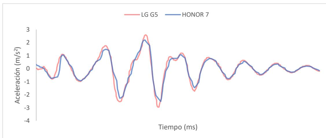
Figura 5.1.3- Superposición de los registros mostrados en la figura 5.1.1
