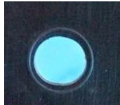
Imagen 2.19. Agujero dentro de tolerancia.
