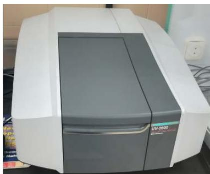
Figura 16. Espectrofotómetro Ultravioleta-Visible modelo UV-2600.
