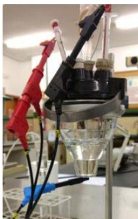
Figura 17. Celda electroquímica de trabajo.
