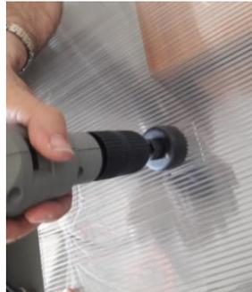
**Figura 3.26.**Detalle del perforado de la lámina para válvula de bypass.
