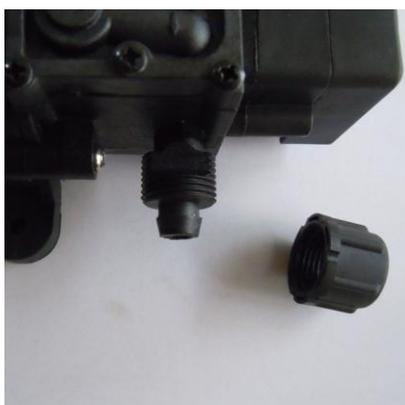
**Figura 3.29.**Detalle de la tobera roscada de la bomba.
