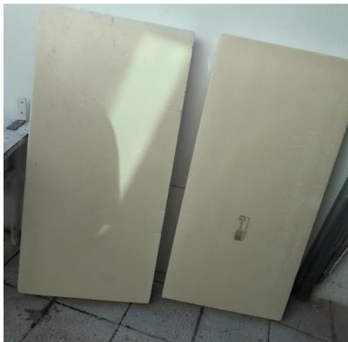
**Figura 3.18.** Láminas de poliestireno extruido
