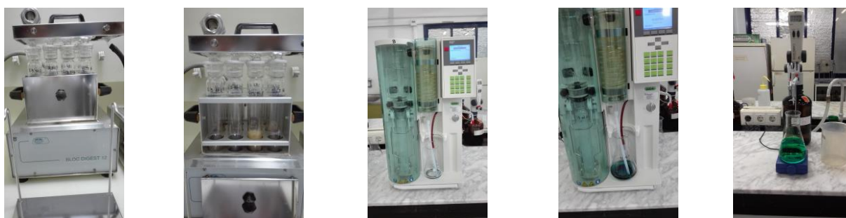
Figura 14. Imágenes tomadas durante el desarrollo del método Kjendahl para el análisis del nitrógeno.
