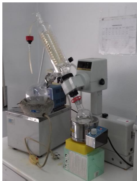
Figura 11. Montaje del destilador rotativo para la concentración de nutrientes a partir del extracto
