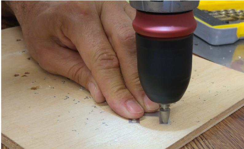
Figura 5.7: Mecanizado mediante broca lima.
