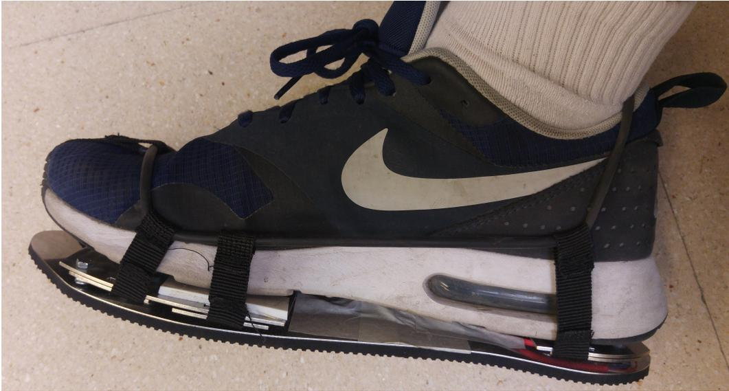
Figura 5.19: Zanco de carga acoplado al zapato del operario.
