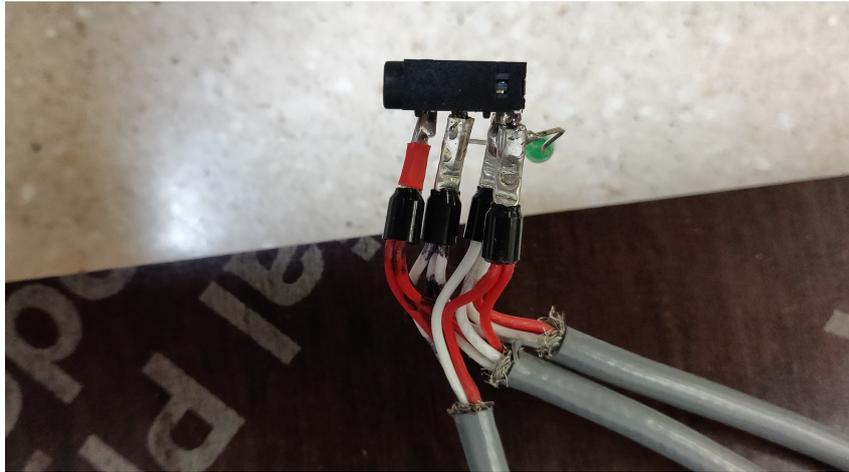
Figura 3.11: Conexiones hembra de jack 3,5 mm.
