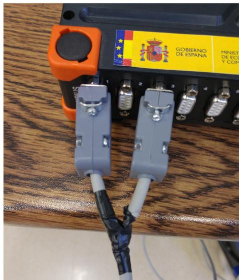
Figura 6.1: Conexión de cada cabezal DB9 a el sistema de adquisición de datos Sirius.
