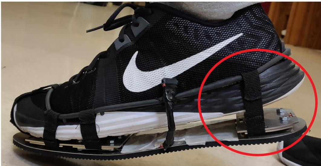
Figura 7.5: Caída y pérdida de contacto físico zapato-zanco en el talón.
