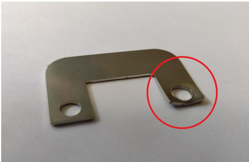
Figura 5.8: Deformación de la pletina inferior provocada por el mecanizado.
