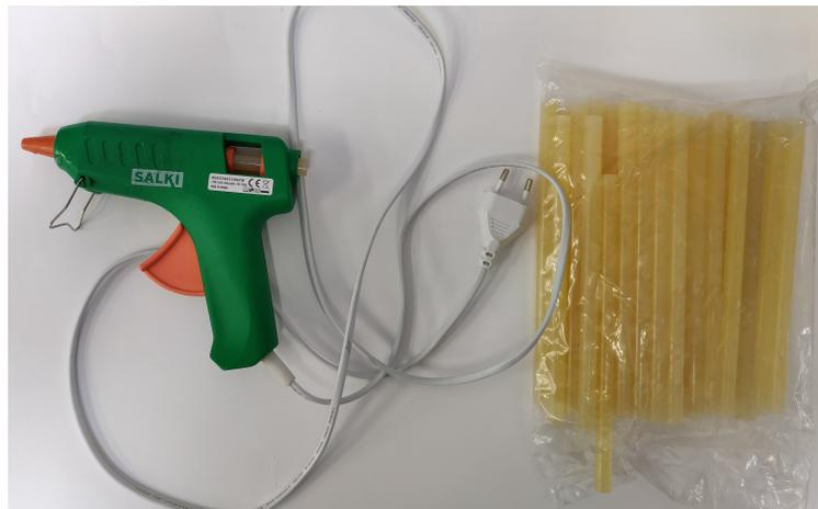
Figura 3.5: Pistola termofusible y cartuchos de cola.
