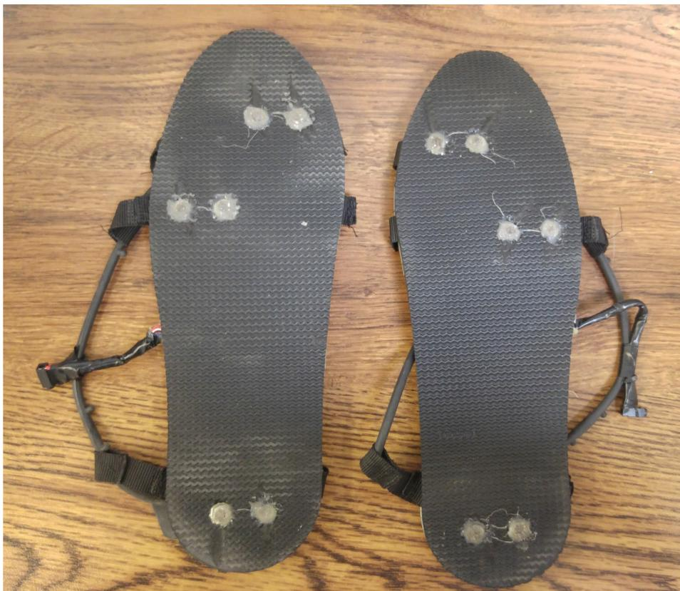
Figura 4.6: Vista de la planta inferior con las suelas de caucho montadas en los zancos.
