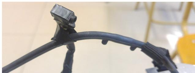
Figura 5.18: Colocación del conector jack de 3,5 mm en el entorno de la goma.
