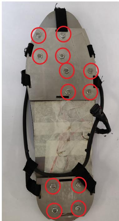
Figura 7.10: Distribución de los tornillos que sobresalen en la suela superior.
