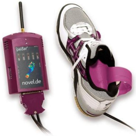
Figura 1.2: Sistema de medición de fuerzas y presiones plantares Pedar© Novel. [1].
