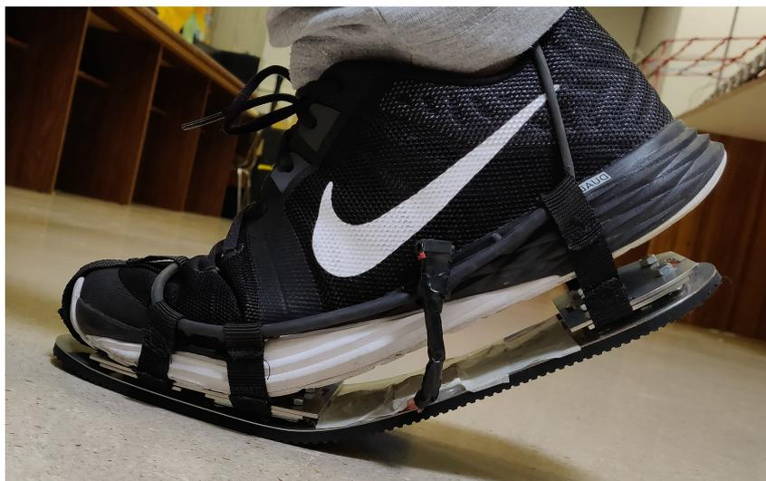
Figura 7.7: Deformación de los zancos durante el inicio de la zancada.
