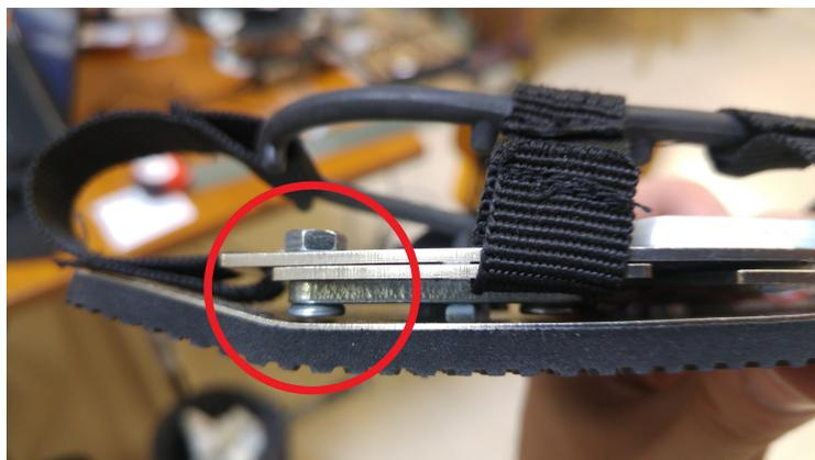
Figura 7.2: Juego entre la cabeza de los tornillos de las uniones superiores y la suela de acero sin carga aplicada.
