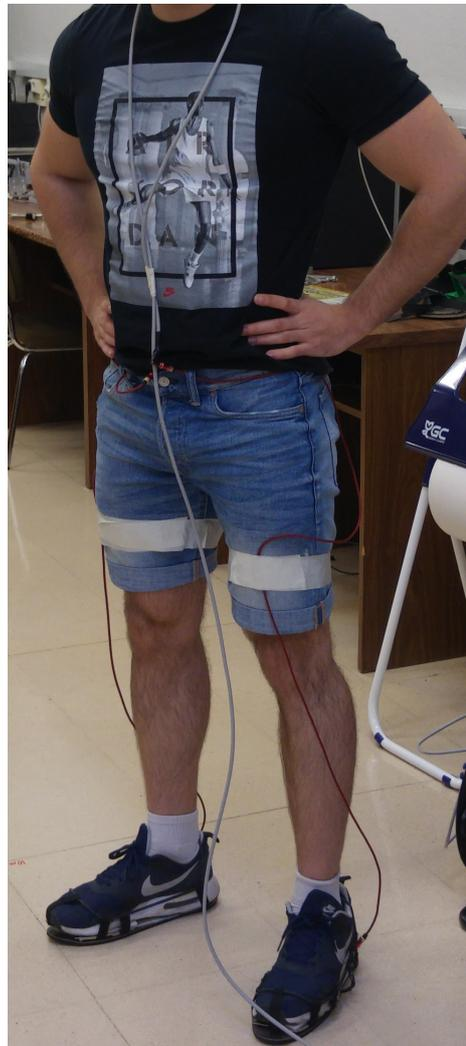
Figura 6.2: Acoplamiento completo de zancos y cableado al operario para la realización de ensayos.
