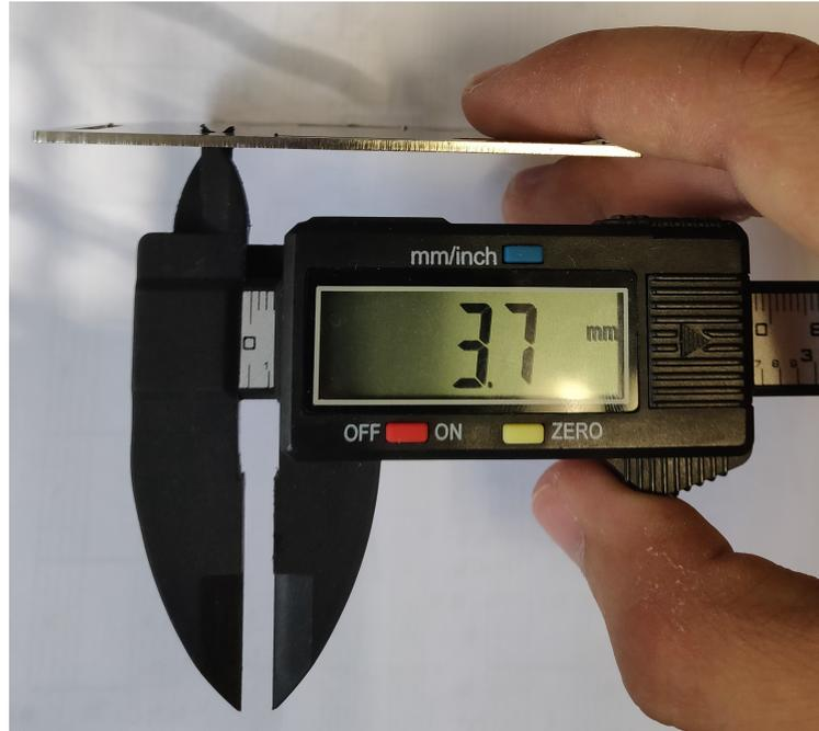
Figura 5.3: Ejemplo de medida interior con el pie de rey digital.
