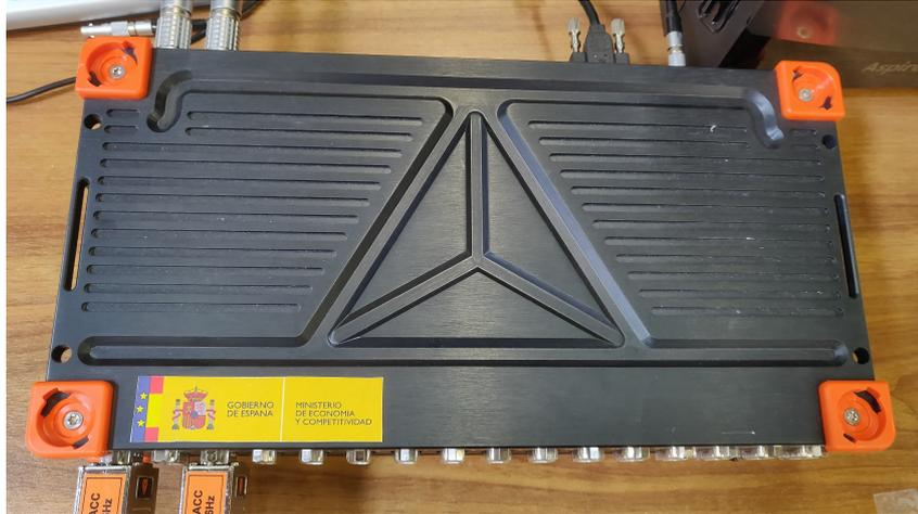
Figura 3.6: Sistema de adquisición de datos Sirius HD-STG.
