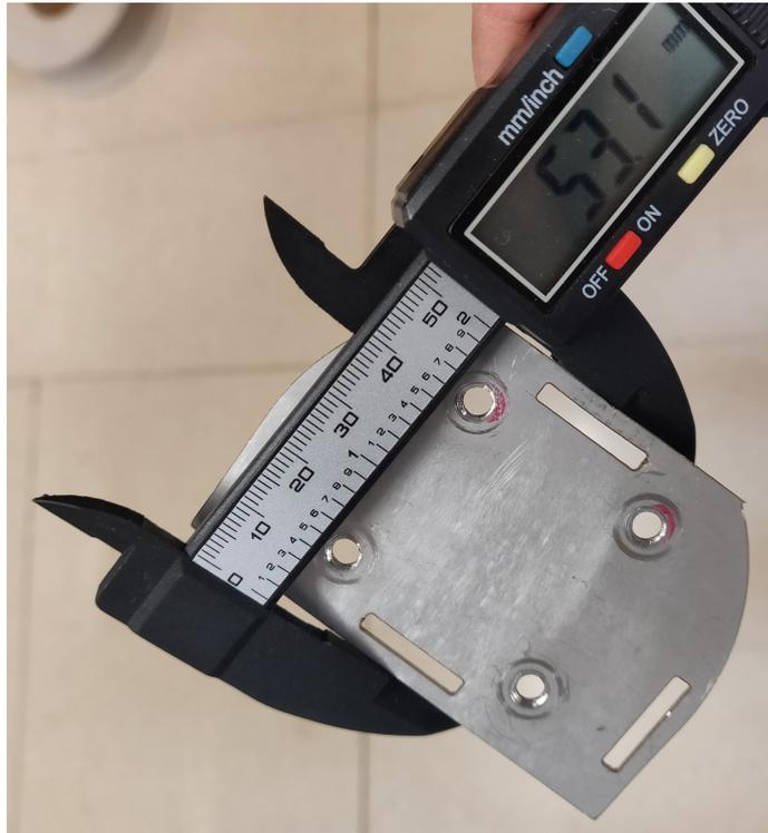
Figura 5.2: Ejemplo de medida exterior con el pie de rey digital.
