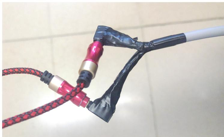
Figura 4.16: Doble conexión jack 3,5 mm.
