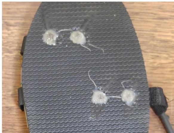
Figura 5.14: Sellado de la unión con cola termofusible.
