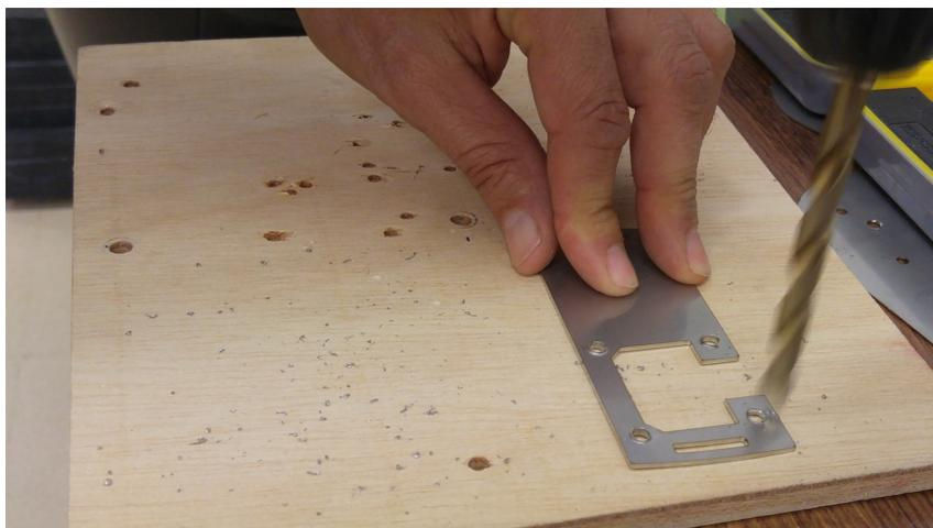
Figura 5.6: Mecanizado de una pletina superior.
