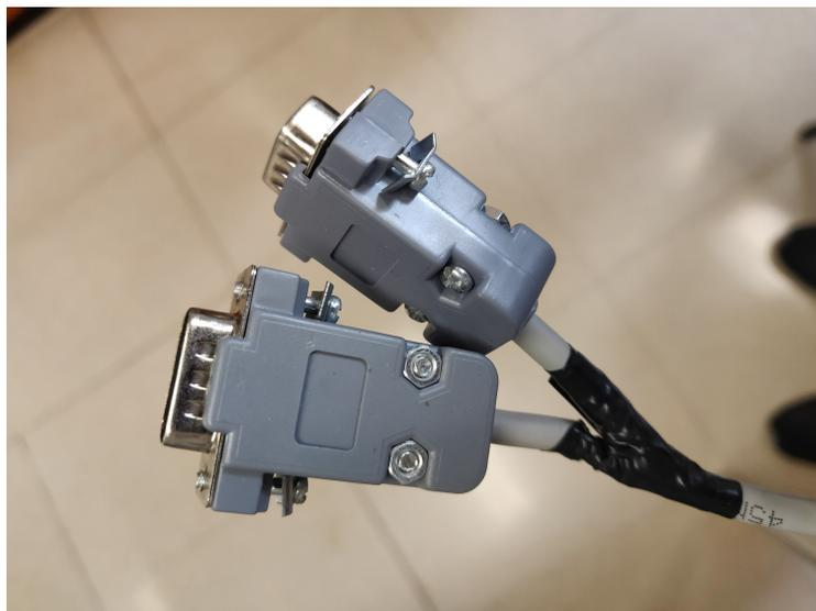
Figura 4.17: Doble conexión DB9.
